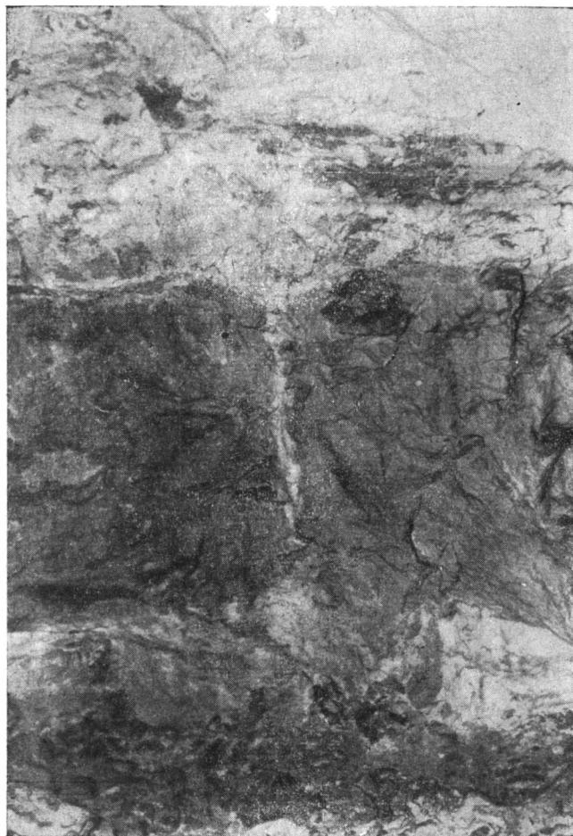
Фиг. 2. Псевдоморфное замещение ангидрита (темное) скрытокристаллическим гипсом (светлое)
