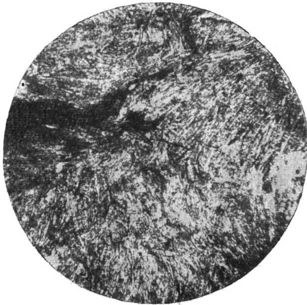
Фиг. 3. Нематобластовая неориентированная структура ангидрита. Черное — включения глины. Диаметр поля 3 мм
