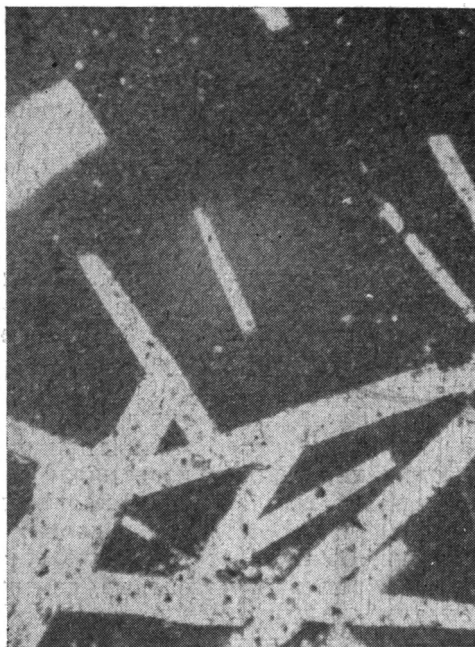
Фиг. 2. Известняк пелитоморфный с включениями удлиненных кристаллов гипса (светло-серое), содержащих реликты ангидрита (серое, рельефное)
