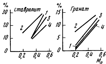
Фиг. 5. Линии регрессии между содержанием ставролита (0,5—0,25 мм), граната (0,25—0,17 мм) и средним размером зерен осадка для различных участков Вятки 1—4 — участки р. Вятки (табл. 5)
