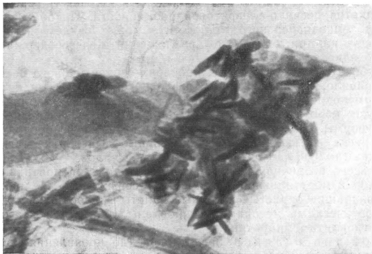
Фиг. 1. Агрегат глинистых частиц, импрегнированный кристаллами гидрогетита (электронный микроскоп); \times 78\,000
