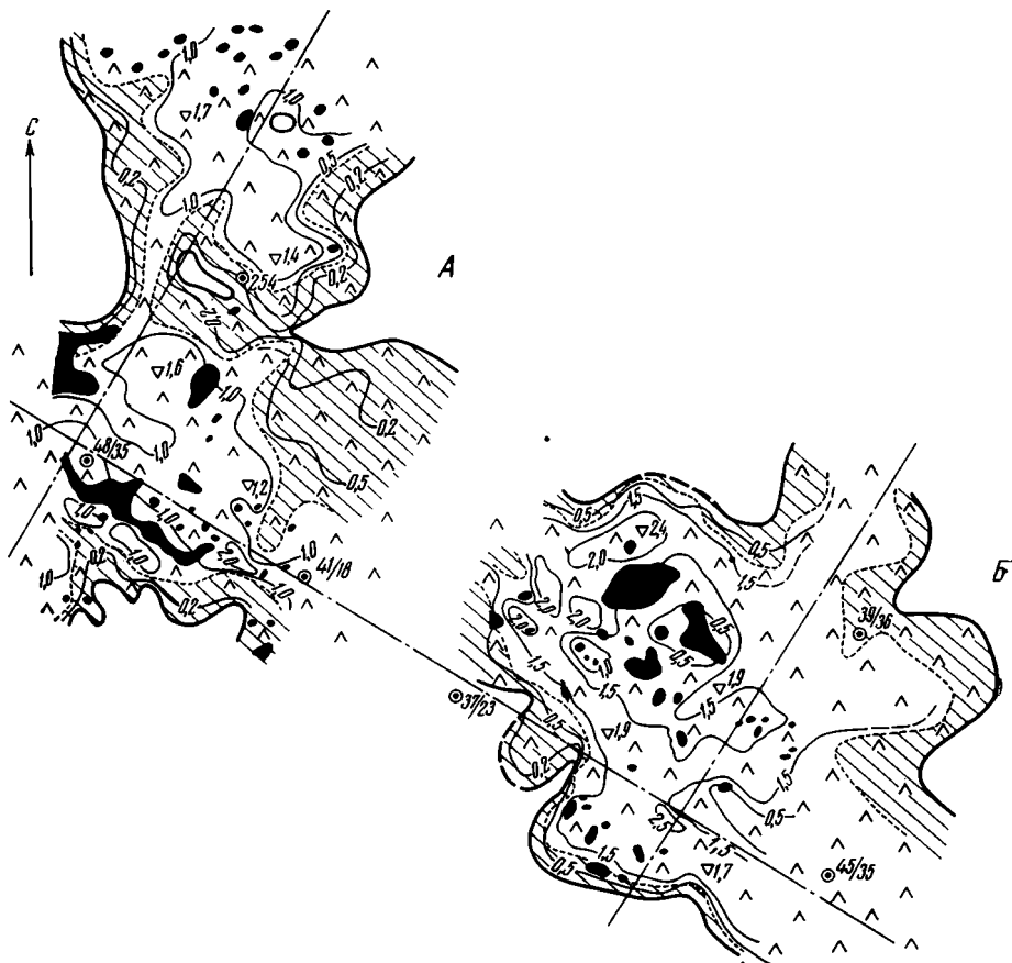
Фиг. 2. План изопакит сероносного горизонта III с расположением зон карстовой нарушенности рудной залежи, по данным эксплуатационной разведки (25×25 м) Условные обозначения см. на фиг. 1. Участки: А — Западный; Б — Центральный
