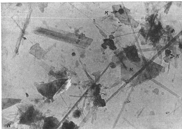
Фиг. 3. Электронно-микроскопические снимки суспензий Чекан, скв. 1 глубиной 2788—2795 м, нижний келловей, \times 1800 . К — каолинит, Г — гидрослюда
