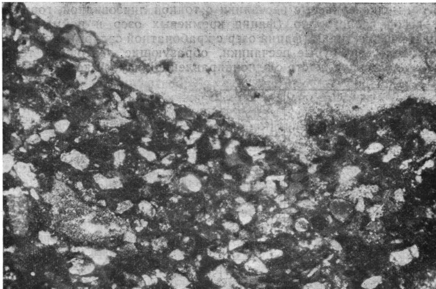
Фиг. 4. Соотношение кремнистого обособления с алевролитом и глинисто-железистым цементом. Микрофото,  $\times 100$
