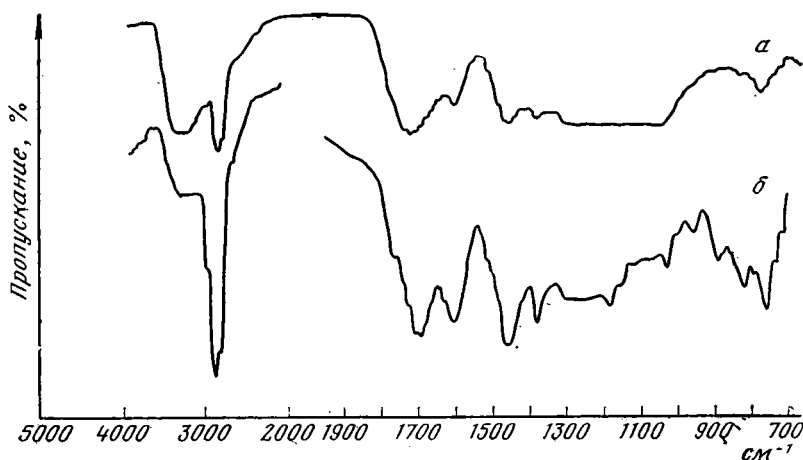
Фиг. 2. ИК-спектры хлороформенных битумоидов а — уголь р. Мома, ОС(МК 5 ); б — уголь р. Тихон-Юрях, К(МК 4 )
