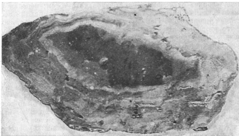
Фиг. 3. Фотография полировки из обломка бокситовой породы, подвергнутой гипергенному преобразованию в залежи валунчатой руды. Наблюдается глубокая проработка материала по периферии обломка при сохранившемся «ядре» неизмененного боксита в его центральной части. Натур. величина
