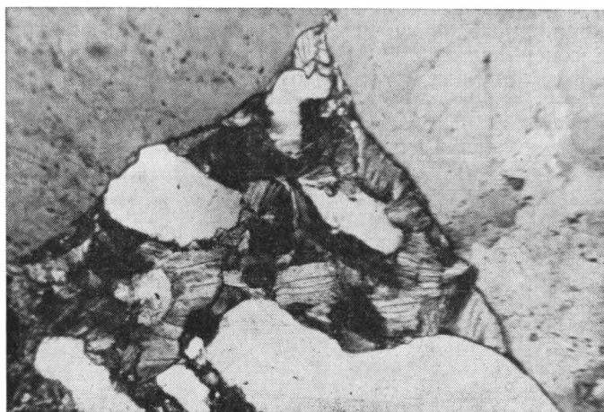
Фиг. 2. Кристаллы диккита и каолинит в изолированном поровом пространстве; николи скрещены, увел. 90. Скв. Анастасьевская 11, глубина 4411—4419 м
