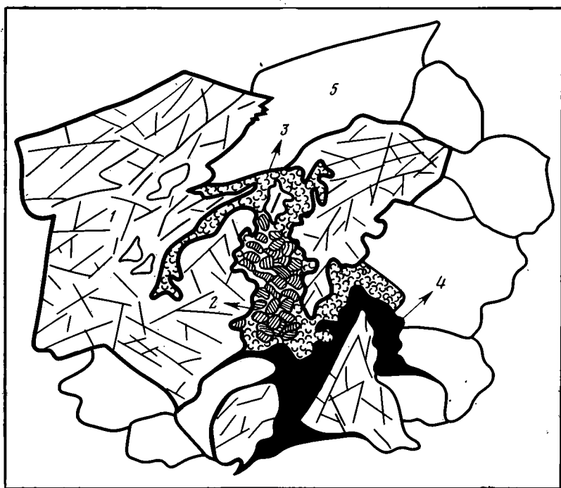
Фиг. 4. Песчаник; Бабчинская площадь, скв. 3, глубина 3289—3294 м, пласт В-26 Заполнение межзернового пространства: 1 — сфалерит, 2 — диккит, 3 — каолинит совершенной структуры, 4 — битумы, 5 — обломки кварца
