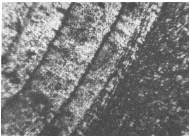
Фиг. 1. Полосчатое строение опоквидных фосфоритов (м-ние Джанатас, ник. скрещены, увел. 90)
