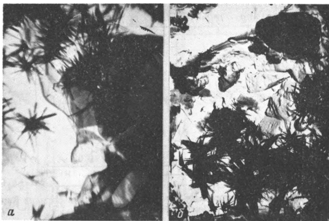
Фиг. 2. Пучковидно-игольчатые выделения гидроксидов железа (м-ние Джанатас, ПЭМ, самооттененные угольные реплики); увел. 30 000 (а) и 10 000 (б)
