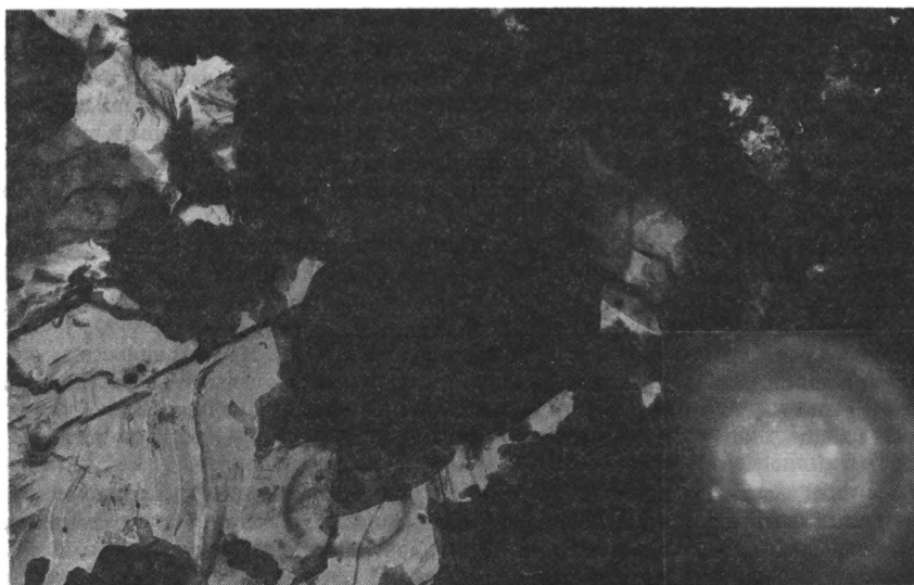
Фиг. 3. Овальное зерно силиката урана — коффинита в тонкодисперсном цементе. Увел. 16 000. На вклейке приведена точечная микродифракционная картина коффинита
