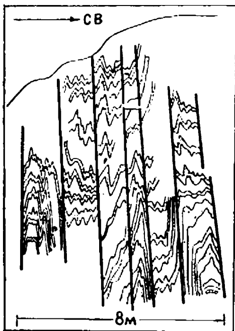
Рис. 52. Кливажные разрывы в известково-глинистой пакке аксумбинской свиты по ручью Аксумбе. Рисунок с фотографии.
