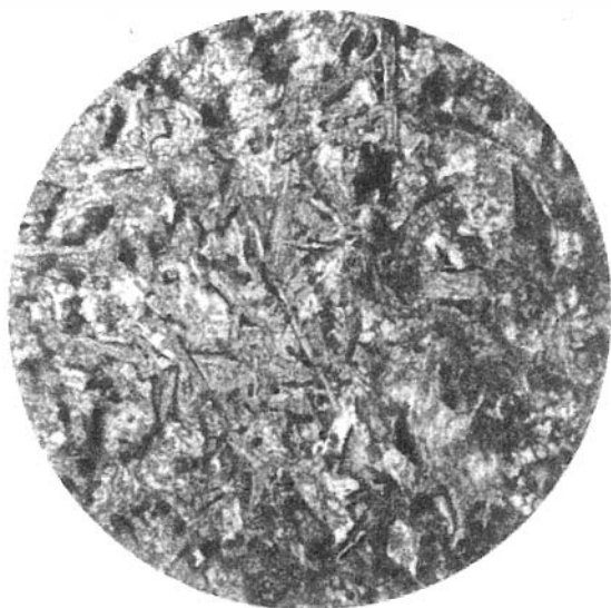
Фиг. 36. Спессартит. Призматически-зернистая структура. Преобладание игольчатых кристаллов роговой обманки над плагиоклазом. Обр. 145, между п. X и X1. Без анализатора, увел. 20
