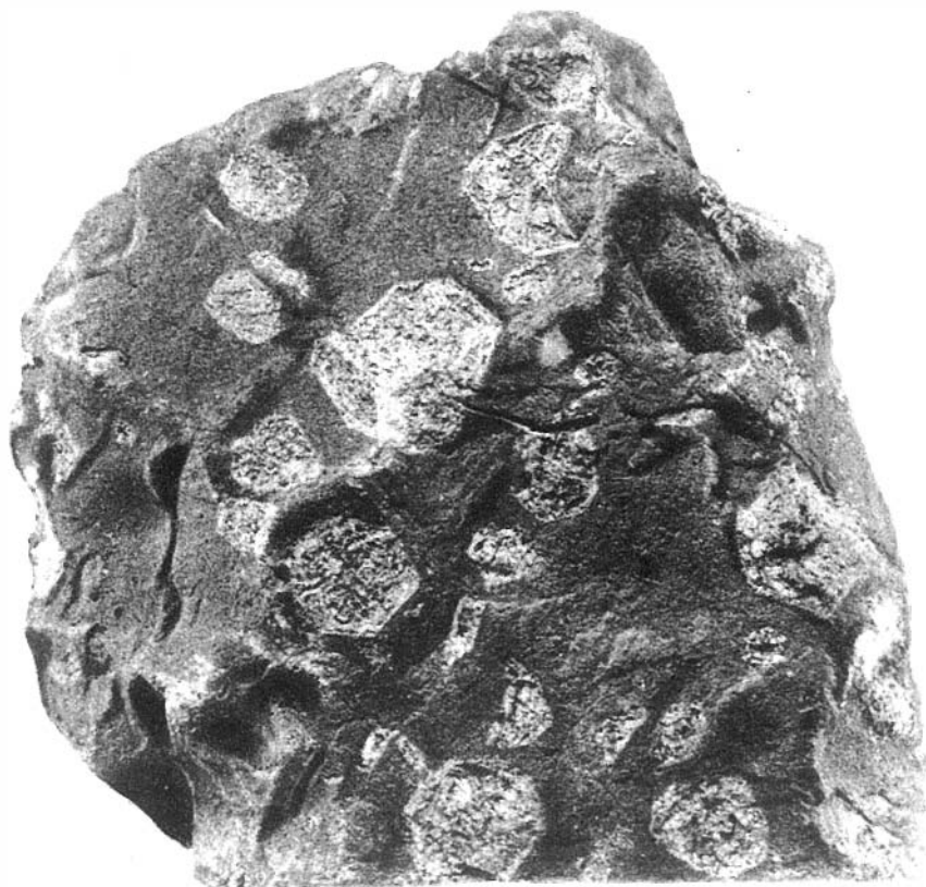
Фиг. 7. Псевдолейцитовый порфир. Ровная выветрелая поверхность образца. Видно внутреннее строение псевдоморфоз по лейциту, так как на месте зерен нефелина при выветривании образуются углубления. Натур. вел.
