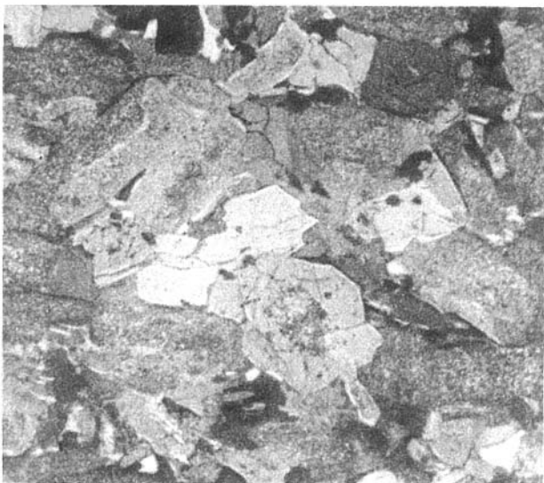
Фиг. 34. Кварцевый диорит. Типичная гипидиоморфнозернистая структура. Количество кварца в поле зрения несколько меньше среднего. Обр. 175, севернее п. XIV. Никколи скрешены, увел. 15
