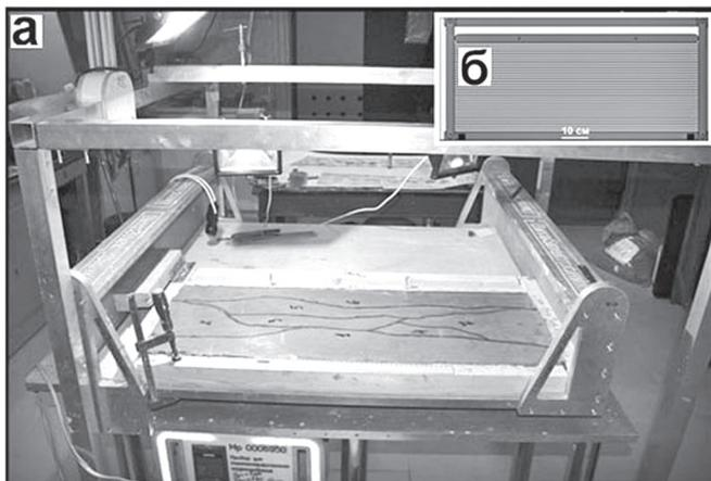
**Рис. 1.** Прибор для тектонофизического моделирования: а – к столешнице прибора прикреплено приспособление, на дне которого находится образец из глины, с наложенным трафаретом, соответствующим блоковому строению БРЗ; б – схема, показывающая устройство приспособления для моделирования сдвига в широкой зоне
