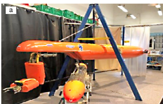
Рис. 1. Подводный глайдер и демонстратор технологии легкого интервенционного АНПА (ЛИ-АНПА) производства АО «НПП ПТ «Океанос» на стенде (а) и в экспериментальном бассейне СПбГМТУ (б)
