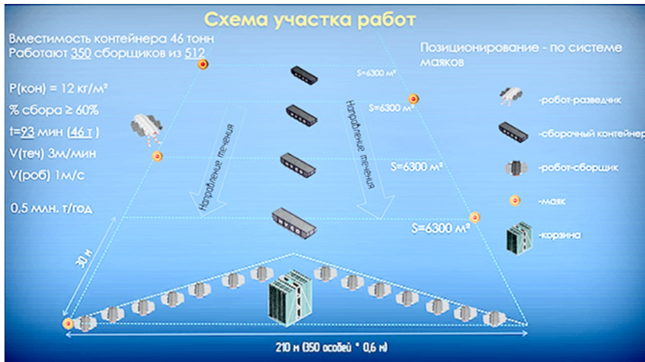
Рис. 2. Схема добычи конкреций с использованием «роя» роботов
