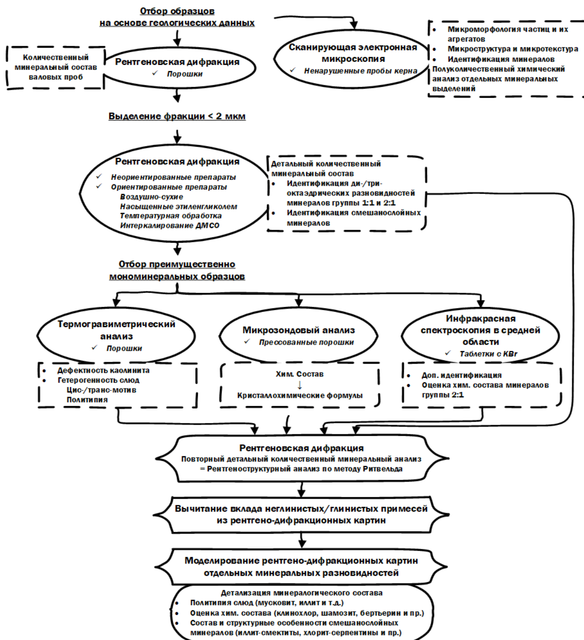
Рисунок. Схема методического подхода изучения глинистых минералов
